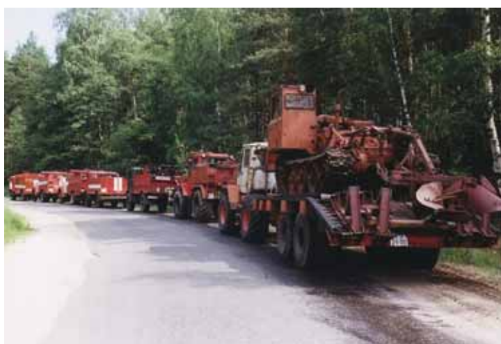
Рис. 3.46. Спектр специализированной техники ПХС включает пожарные машины и тракторы, бульдозеры и пр.
