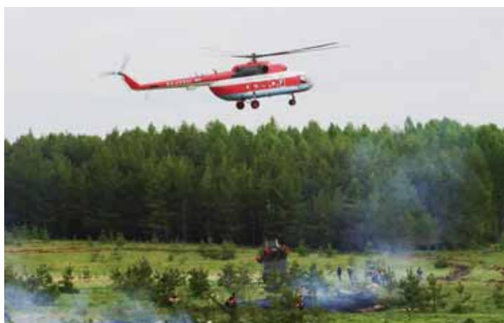
Рис 3.61. Доставка лесопожарного трактора на внешней подвеске к месту тушения пожара
