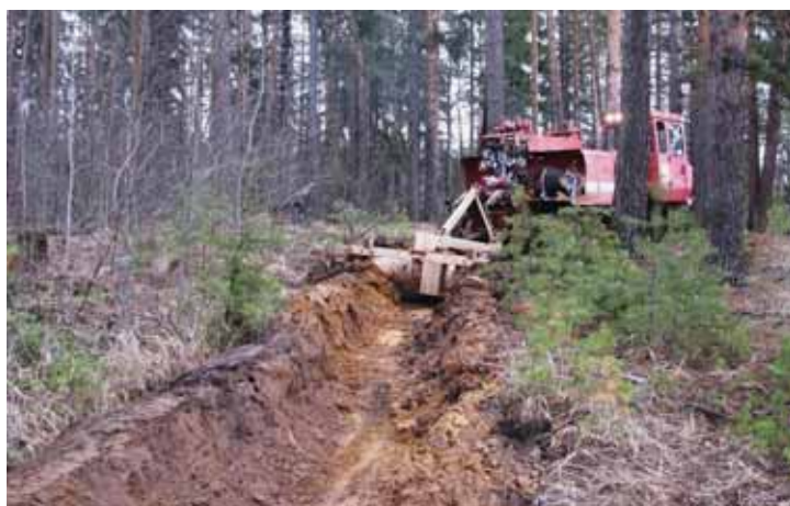
Рис. 3.43. Организация противопожарного обустройства лесных участков. Создание минерализованных полос
