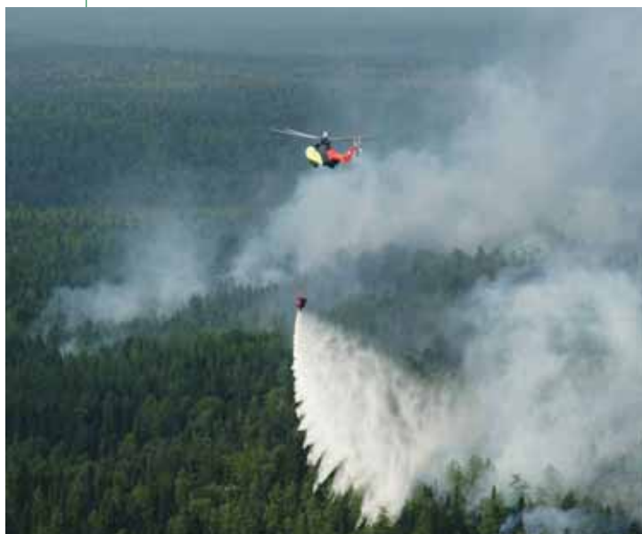
Рис. 3.62. Применение тяжелых вертолетов Ми-26 для тушения лесных пожаров. Ханты-Мансийская база авиационной и наземной охраны лесов от пожаров, 2012 г.
