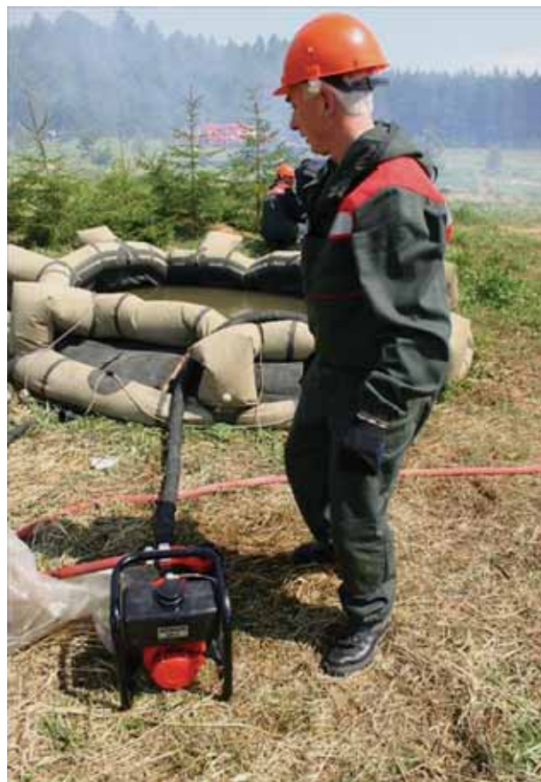
Рис. 3.54. Применение десантниками-пожарными переносных мотопомп
